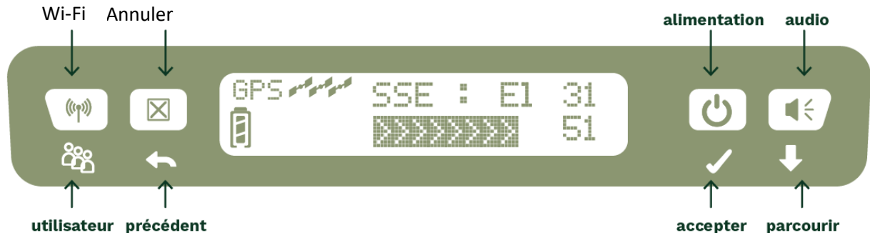
Figure 4 : Azimut et angle d'élévation du satellite Echostar T1
